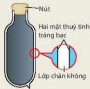
Hình 28.6 Cấu tạo ruột phích (bình thủy)
