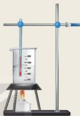
Hình 26.6 Bố trí thí nghiệm theo dõi nhiệt độ của nước khi đun sôi
