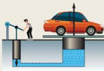
Hình 16.5 Sơ đồ nguyên lý máy nén thủy lực
