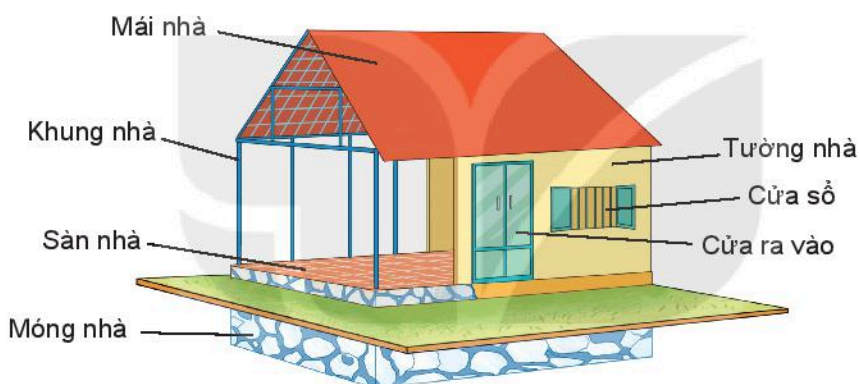
Hình 1.2. Cấu tạo chung của nhà ở
