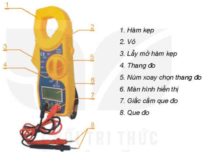
Hình 2.3. Cấu tạo cơ bản của ampe kìm
