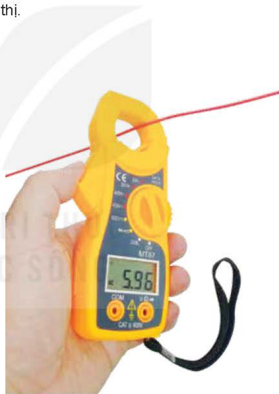
Hình 2.5. Sử dụng ampe kìm để đo cường độ dòng điện
